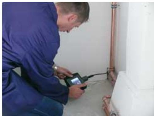
El videoendoscopio inalámbrico PCE-VE 400 / 500 se puede usar de forma inalámbrica o montando la sonda en el soporte.
